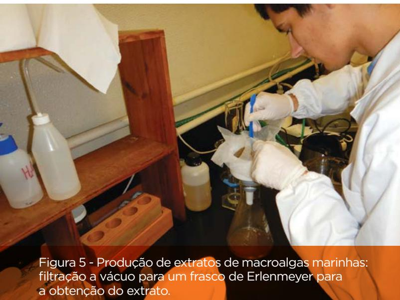
Figura 5 - Produção de extratos de macroalgas marinhas: filtração a vácuo para um frasco de Erlenmeyer para a obtenção do extrato.
